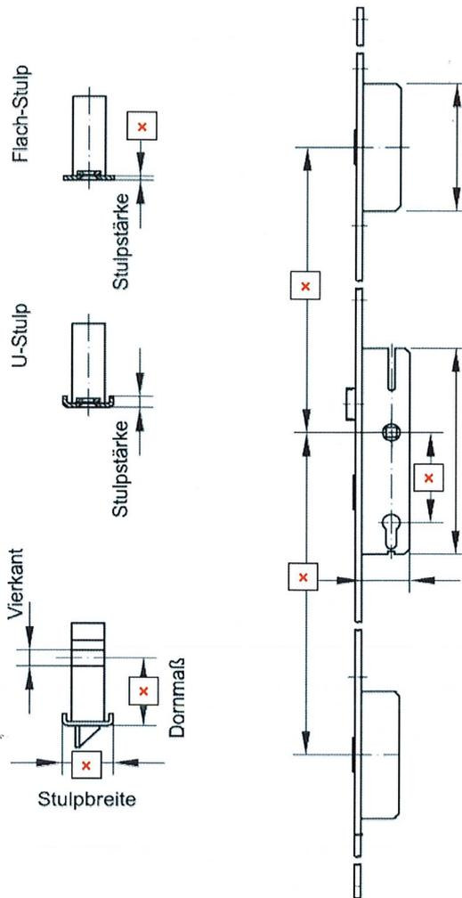
Für die korrekte Bearbeitung Ihrer Schlossanfrage sollten auf jeden Fall die mit  markierten Maße, die Stulpausführung, sowie die Verriegelungsart eingetragen werden!
